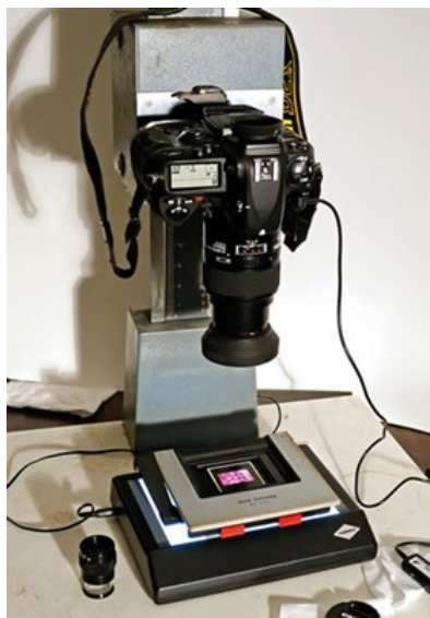
Slika 6. Fotoaparat kao skener (Izvor: http://photosbybmw.com/Tutorial_pages/scanner.html )
