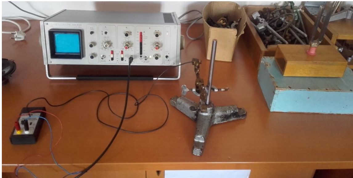
Slika 28. Aparatura za mjerenje frekvencije glazbene vilice
