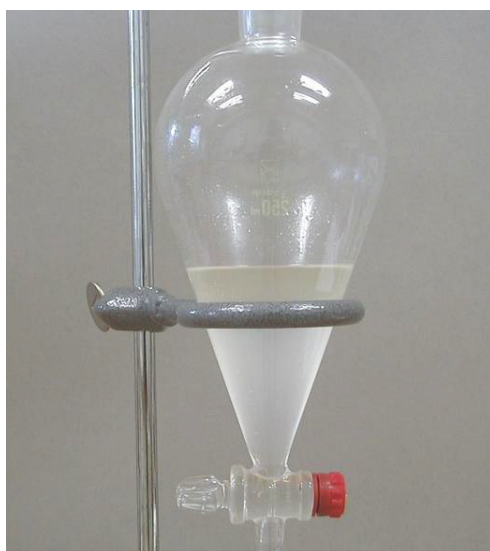
Slika 7. Lijevak za ekstrakciju u kojem se nalaze vodena otopina i organsko otapalo
