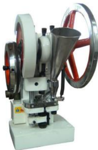
Slika 4.9. Fotografija uređaja za tabletiranje TDP-5T (Zhejiang Wisley Machinery Co. Ltd. Zhejiang, Ruian, NR Kina).
