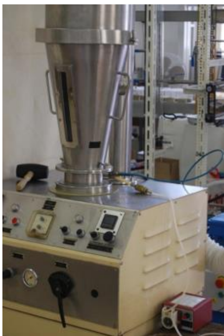
Slika 4.8. Fotografija granulatora s fluidiziranim slojem Uni-Glatt (Glatt GmbH, Binzen, SR, Njemačka).
