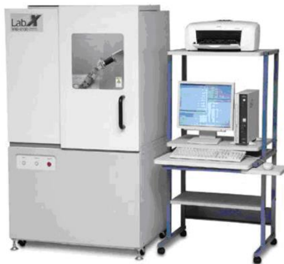
Slika 4.12. Fotografija uređaja za rendgensku difrakcijsku analizu praha XRD-6000 (Shimadzu, Kyoto, Japan).
