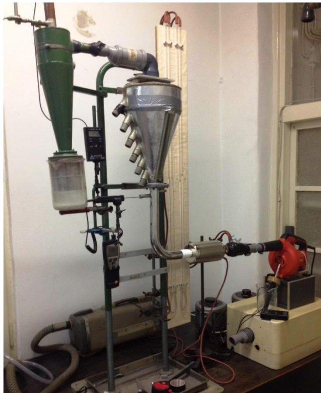
Slika 6. Laboratorijski sušionik s fluidiziranim slojem
