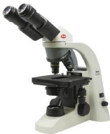
Slika 19. Svjetlosni mikroskop Motic BA200
