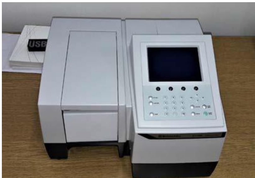
Slika 4.26. Fotografija spektrofotometra UV-1280 (Shimadzu, Kyoto, Japan).
