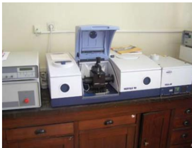
Slika 19. Infracrveni spektrofotometar s Fourierovom transformacijom signala Bruker Vertex 70, ZAKTN, FKIT
