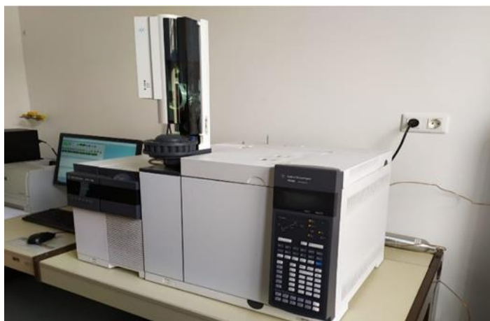
Slika 18. Plinski kromatograf sa spektrometrijom masa (GC-MS).
