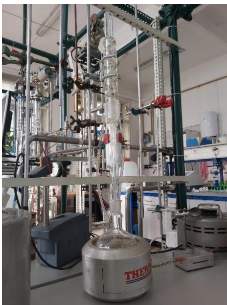
Slika 16. Aparatura za Soxhlet ekstrakciju
