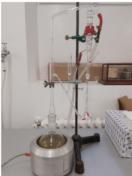
Slika 15. Aparatura za hidrodestilaciju
