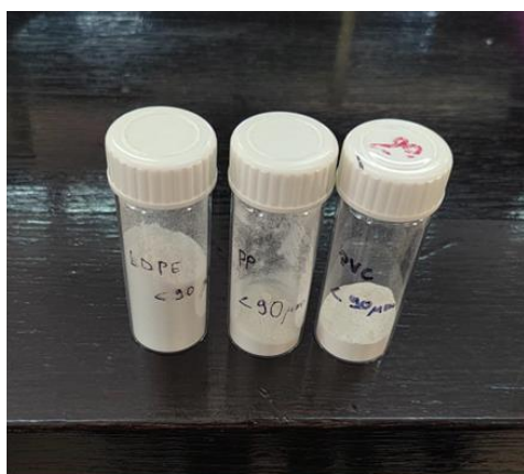
Slika 8. Mikroplastika LDPE-a, PP-a i PVC-a veličine čestica <90 \mu\text{m} .
