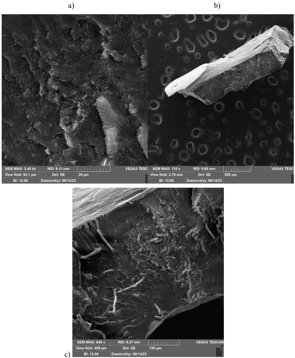
Slika 31. Morfologija hidrogela PVP(1:5)U osušenog metodom ekstrakcije zamrzavanjem: a) površina (povećanje x3000), b) poprečni presjek (povećanje x100) i c) poprečni presjek (povećanje x500)
