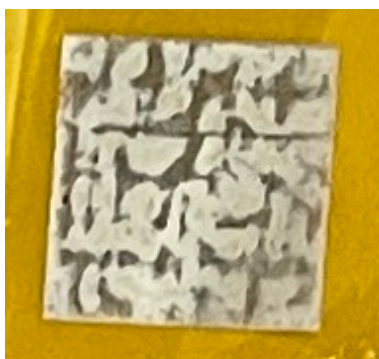
Slika 4.22. Uzorak četiri sloja amfilne tinte na komercijalnoj PI podlozi obrađen energijom od 1600 J pri 3000 V s tri bljeska.
