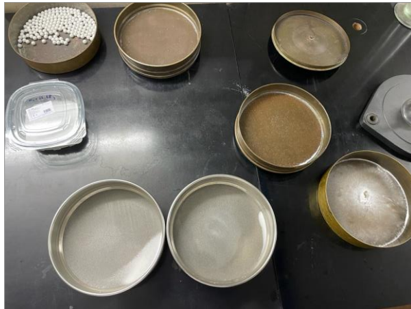
Slika 14. Fotografija sita s prosijanim Pardeckom
