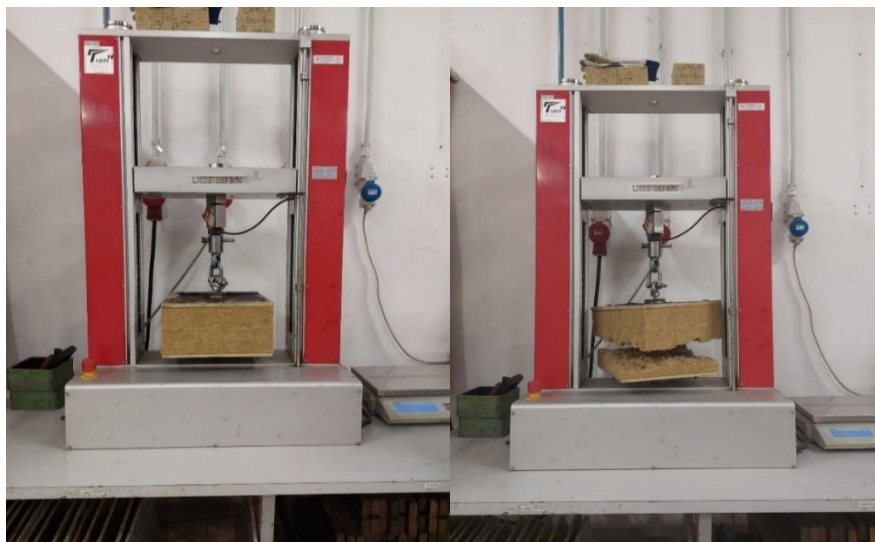
Slika 22. Uređaj Bent Tram, mjerenje delaminacijske čvrstoće.
