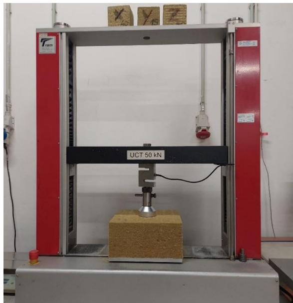
Slika 17. Uređaj Bent Tram, mjerenje točkastog opterećenja.
