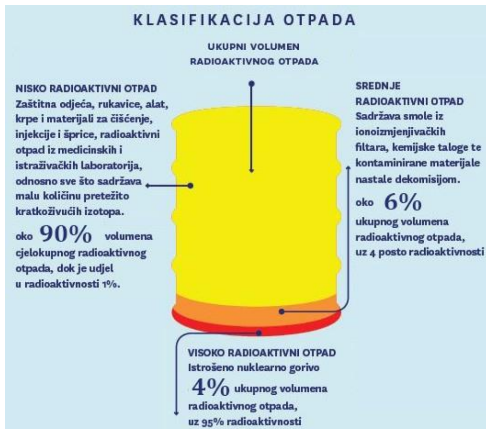
Slika 15. Klasifikacija radioaktivnog otpada [12]
