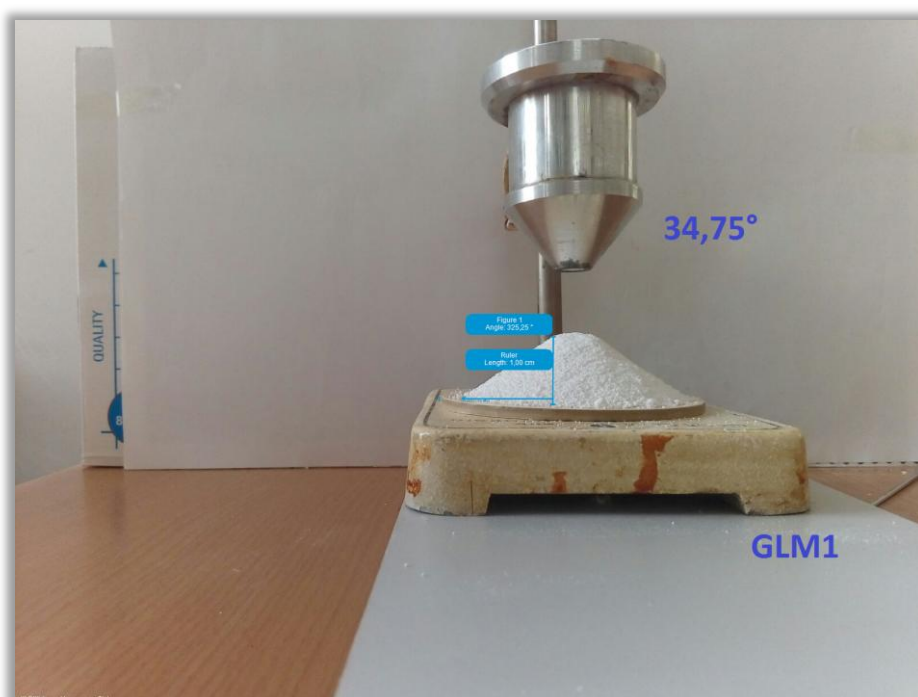
Slika 4.14. Fotografija prikaza mjerenja kuta mirovanja za kolektiv GLM1.
