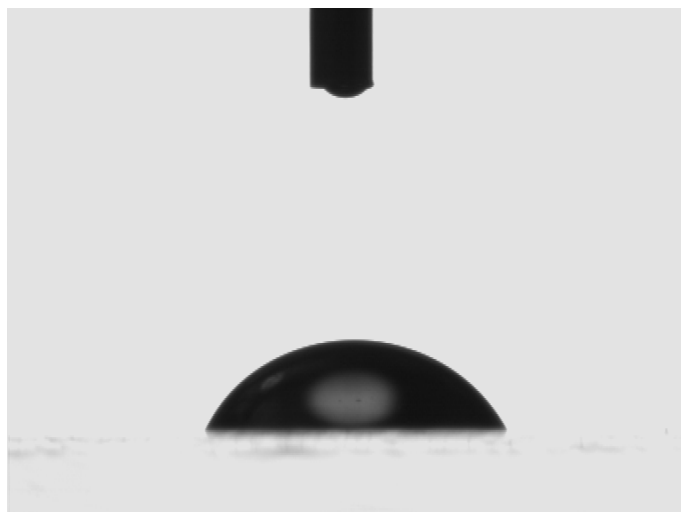
Slika 26. Kontaktni kut vode na površini čistog stakla ( \theta=63^\circ )
