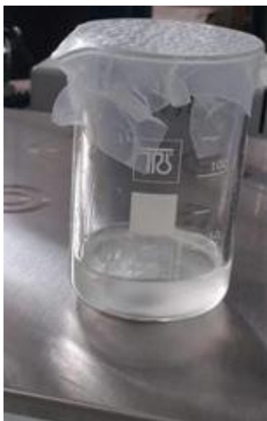
Slika 22. Otapanje NaOH u metanolu
