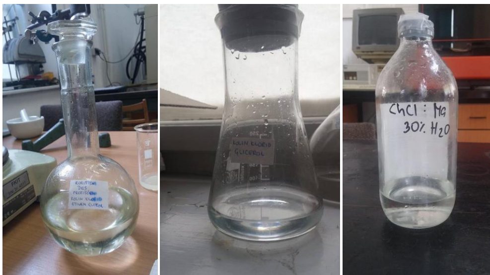
Slika 20. Pripravljena eutektička otapala
