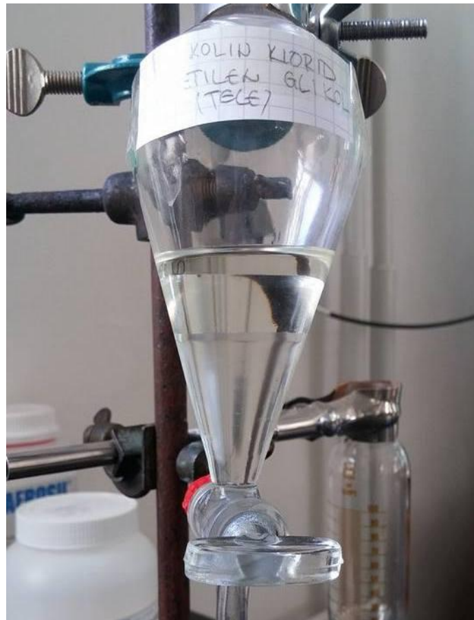
Slika 28. Separacija biodizela i eutektičkog otapala
