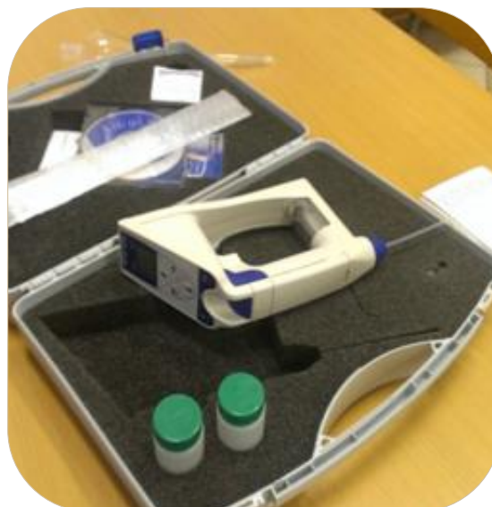
Slika 29. Uređaj za mjerenje gustoće
