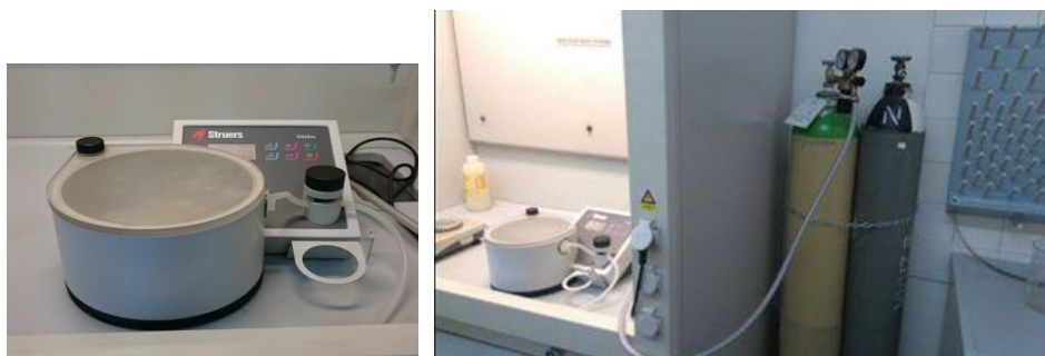
Slika 15. Uređaj za vakuumsku impregnaciju (CitovacStruers)
