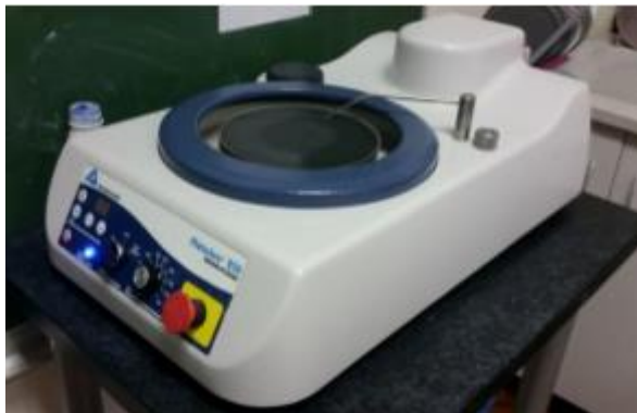
Slika 5. Uređaj za poliranje Buehler MetaServ 250, Grinder – Polisher
