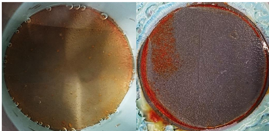
Slika 26. Izgled uzorka 3 nakon 8 dana (lijevo) i nakon 30 dana (desno)
