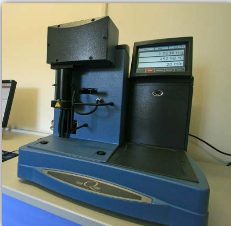
Slika 3.8. Fotografija uređaja za termogravimetrijsku analizu Q500 (TA Instruments, New Castle, SAD).
