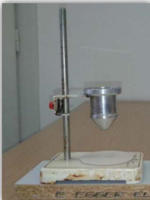
Slika 3.4. Fotografija lijevka za određivanje kuta mirovanja (Zavod za mehaničko i toplinsko procesno inženjerstvo, FKIT).
