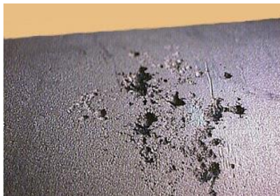
Slika 14. Preklapanje jamičastih udubljenja [24] .
