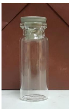
Slika 3.1. Kotlasti reaktor V = 5\text{ cm}^3
