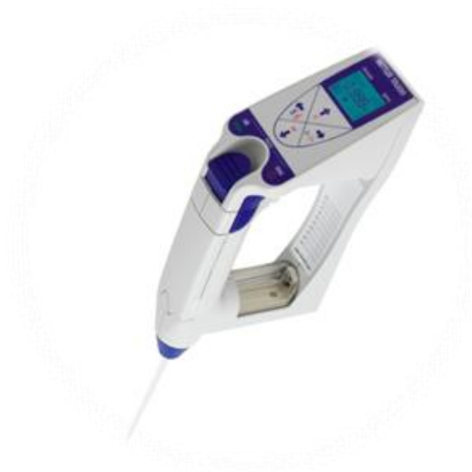
Slika 3.3. Mettler toledo densitometer 30PX Određivanje viskoznosti.
