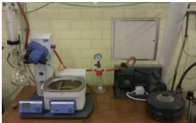
Slika 3.1. Rotacijski vakuum isparivač IKA RV 10, Basic
