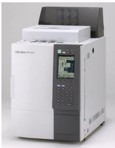
Slika 3.10. Plinski kromatograf Shimatzu GC 2014
