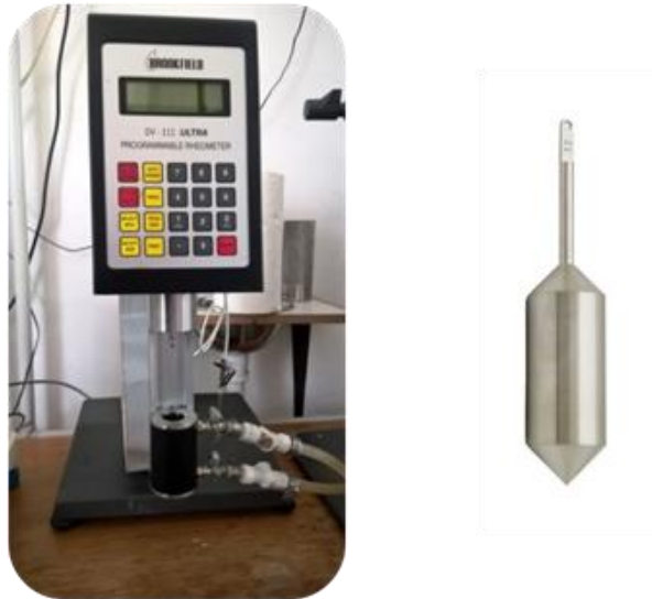
Slika 3.4. a) Rotacijski viskozimetar Brookfield DV – III ULTRA , b) vreteno SC4-21
