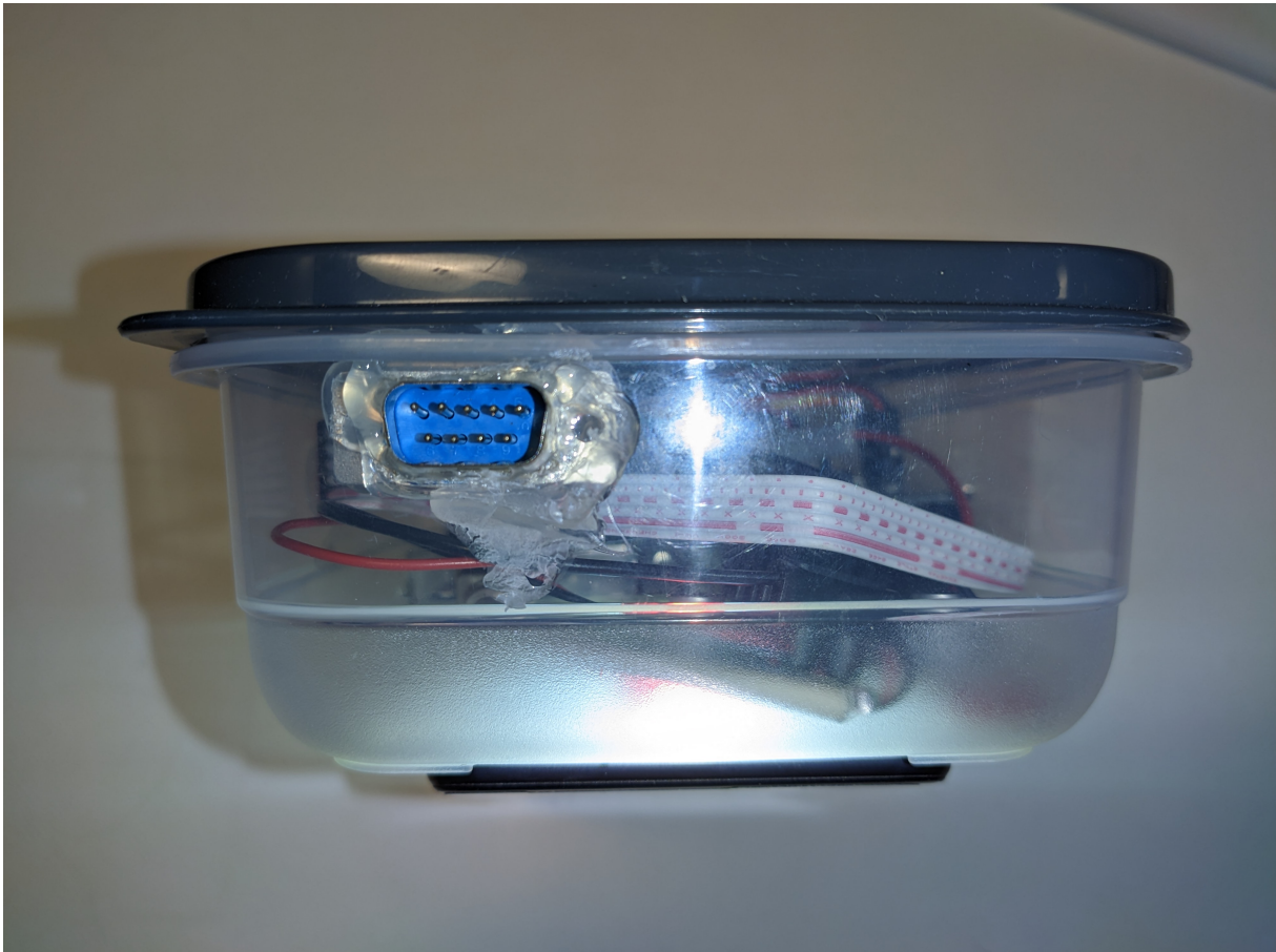
Slika 29 Kutija s Arduino-m i samotni konektor
