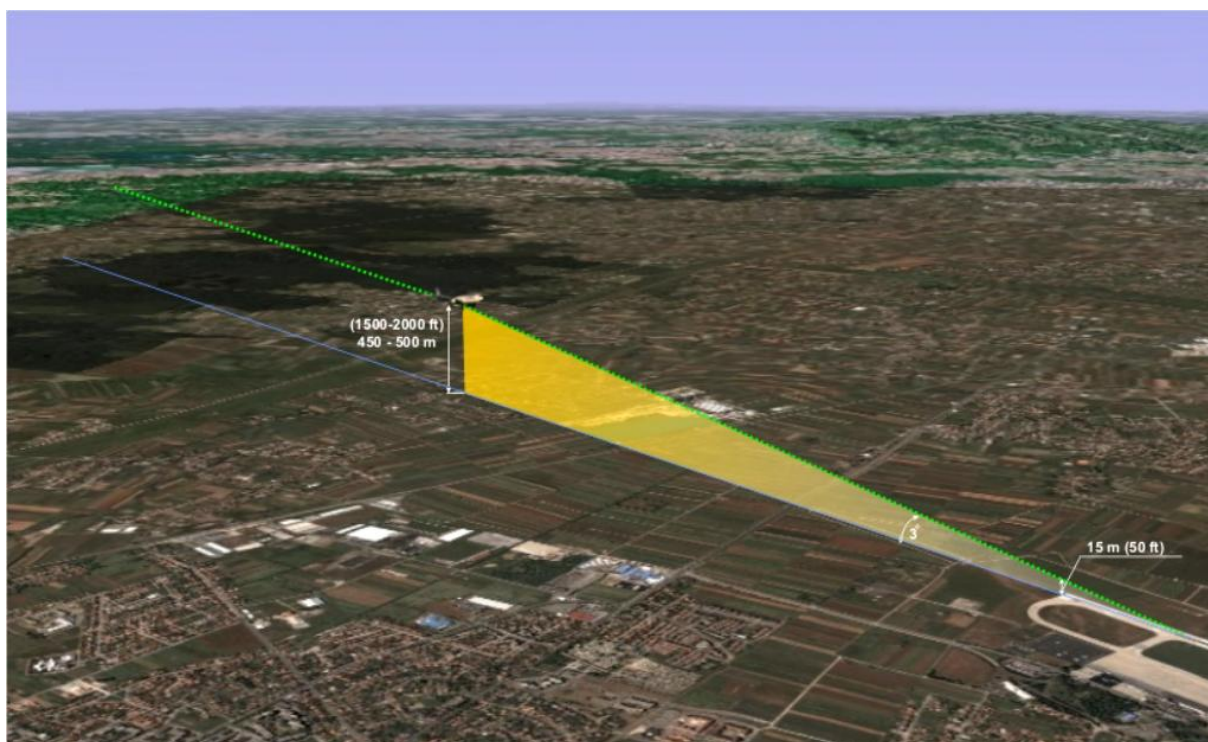
Slika 18. Standardni postupak slijetanja na MZLZ, [6]
