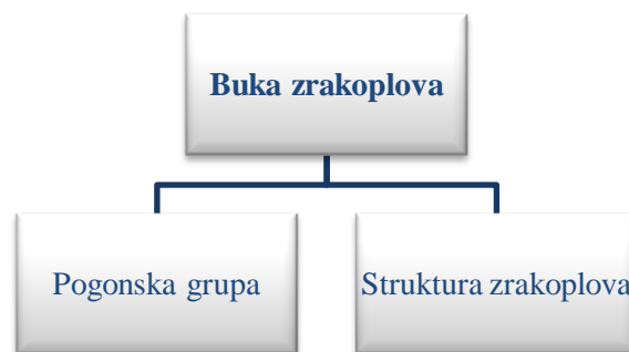
Slika 3. Izvor buke na zrakoplovu,
