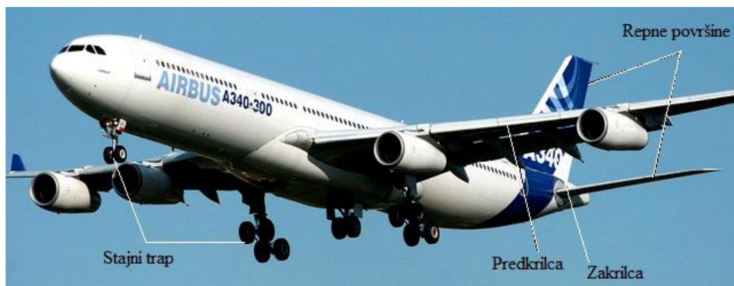
Slika 5. Izvor buke strukture zrakoplova, [7]
