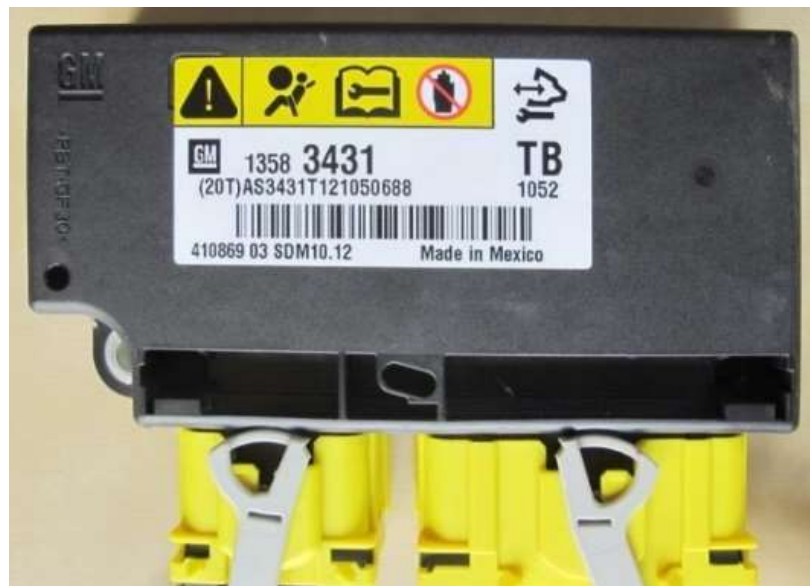
Slika 1. Event Data Recorder (EDR) uređaj sa svom opremom
