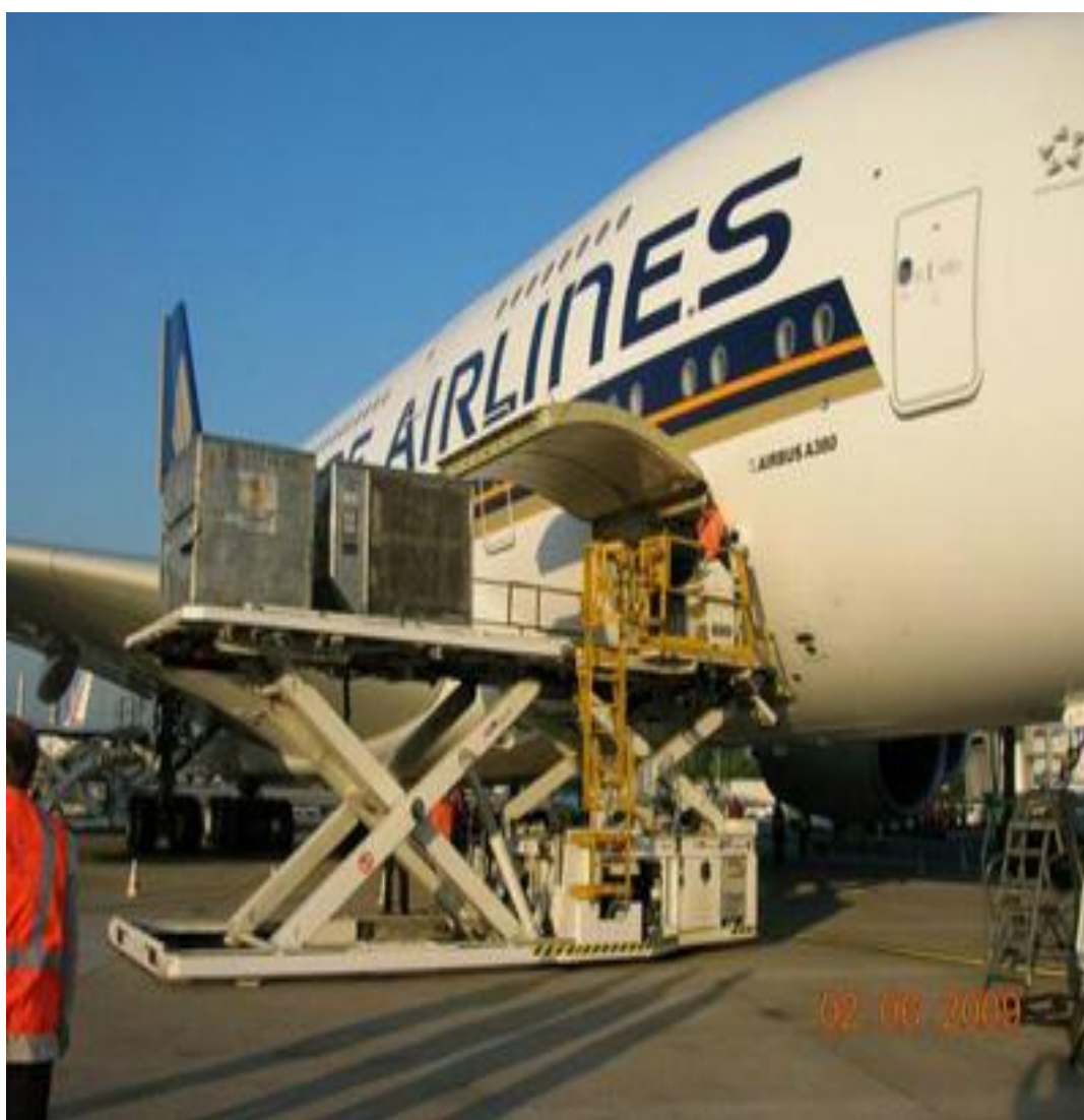
Slika 8: Istovar ULD-a pomoću Cargo utovarivača
