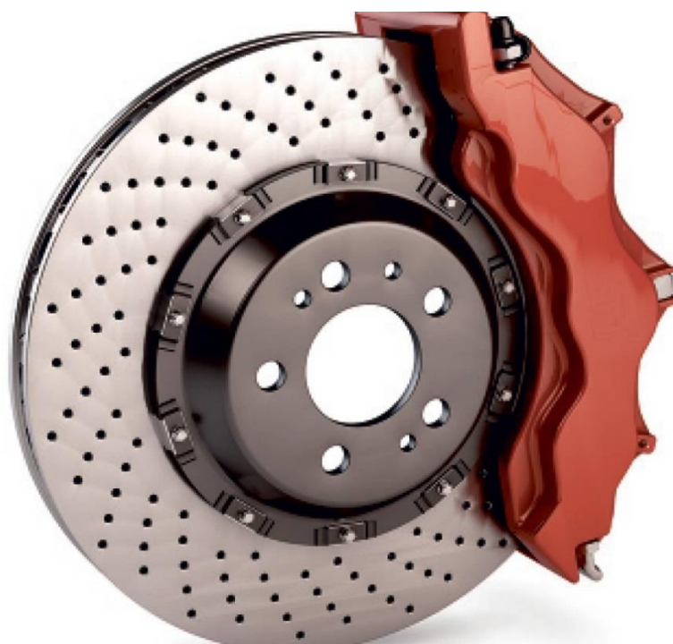
Slika 21. Ventilirajući kočni disk
