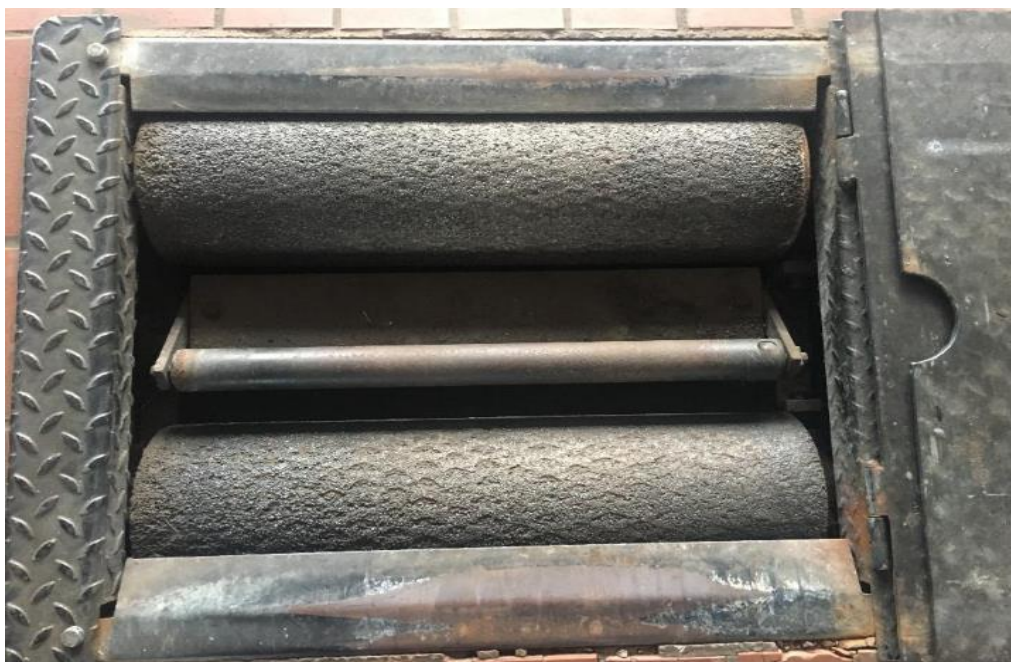
Slika 22. Valjci za ispitivanje kočnica
