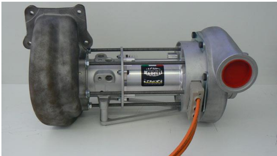
Slika 23. Spoj motor-generatora toplinskog (MGU-H) i turbopunjača
