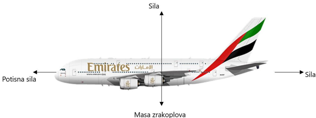
Slika 1. Djelovanje aerodinamičkih sila na zrakoplov
