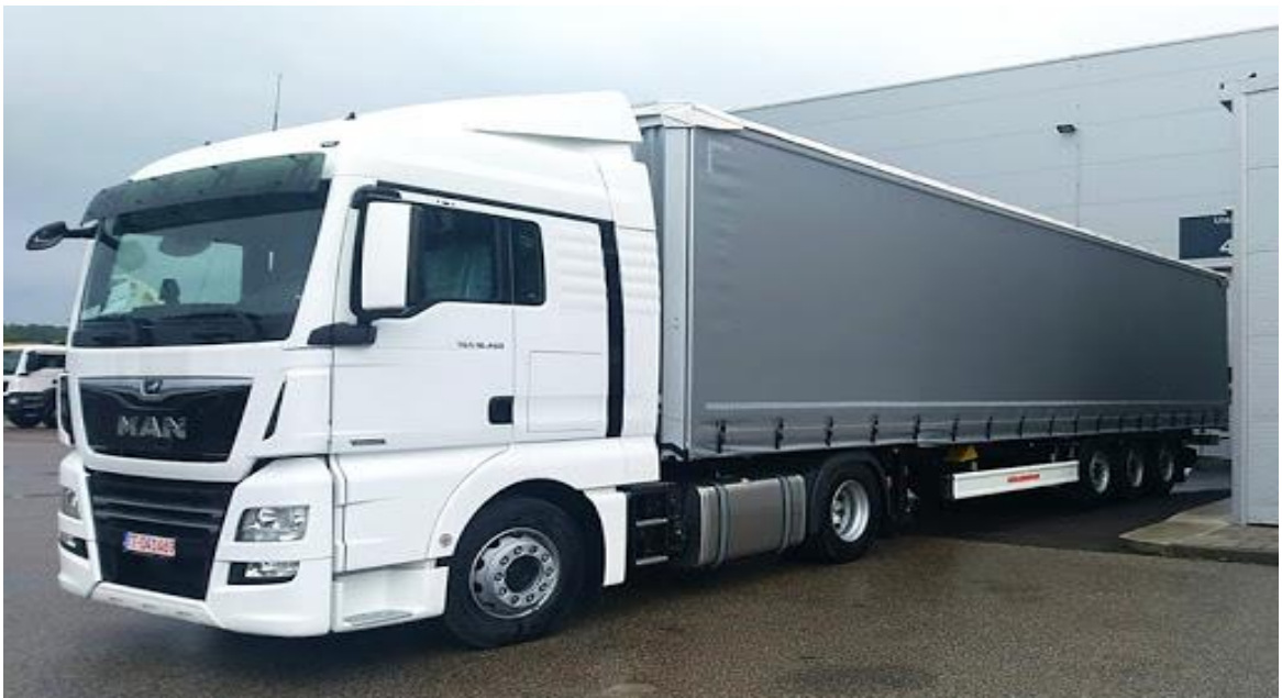
Slika 11: Dvoosovinski tegljač s troosovinskom poluprikolicom
