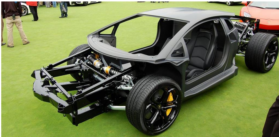
Slika 21: Nosivi okviri Lamborghini Aventador
