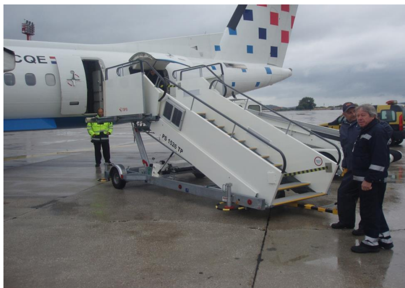
Slika 3. Proces postavljanja putničkih stepenica na avion, [3]
