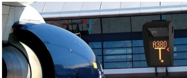
Slika 5. Prikaz navođenja zrakoplova A380 na poziciju pomoću vizualnog sustava navođenja zrakoplova, [10]
