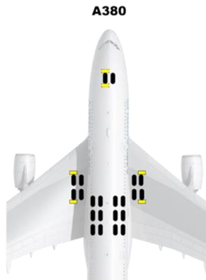
Slika 7. Raspored postavljanja podmetača pod kotače zrakoplova A380 tijekom kraćeg zaustavljanja, [14]
