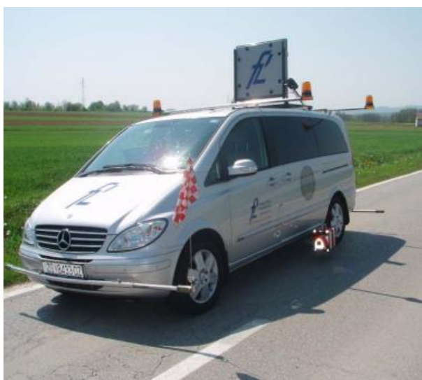
Slika 31. Mjerno vozilo za dinamičko ispitivanje oznaka na kolniku
