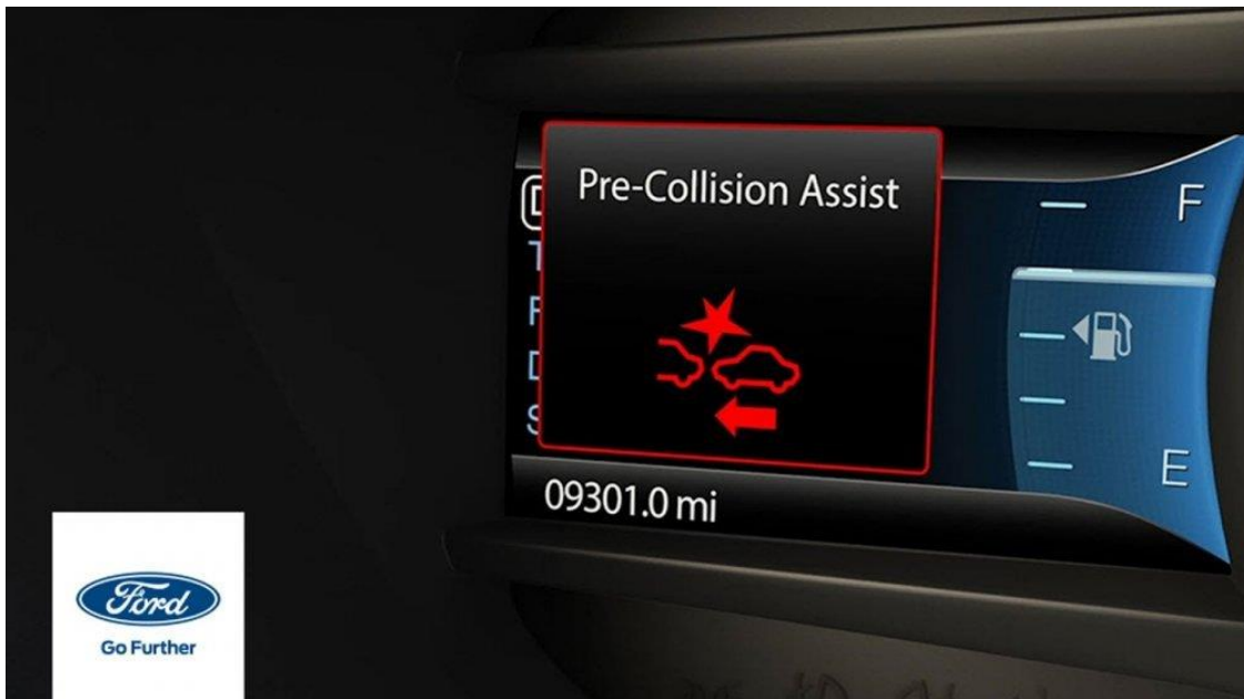
Slika 13. Sustav automatskog kočenja u slučaju opasnosti
