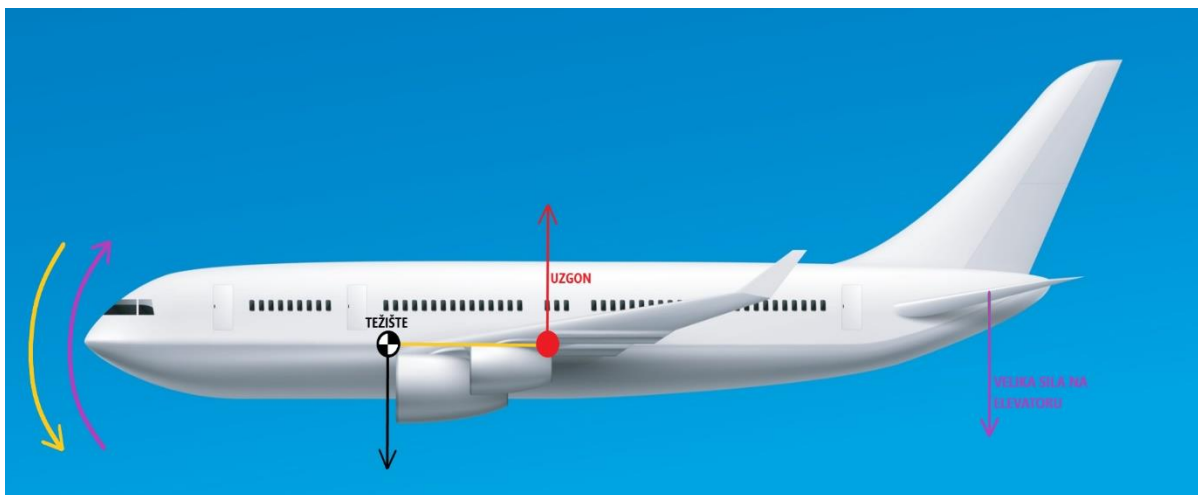
Slika 8. Težište pomaknuto prema prednjoj granici Izvor [9]
