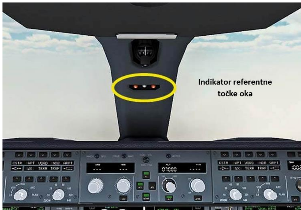
Slika 3.8 Indikator referentne točke oka
