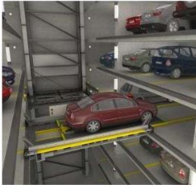
Slika 11.: Pomična platforma po horizontalnoj i vertikalnoj osi; [10] www.koch.hr
