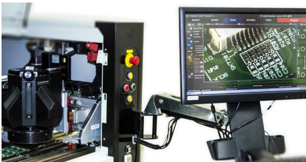
Slika 1. Automatska Optička Inspekcija [4]
