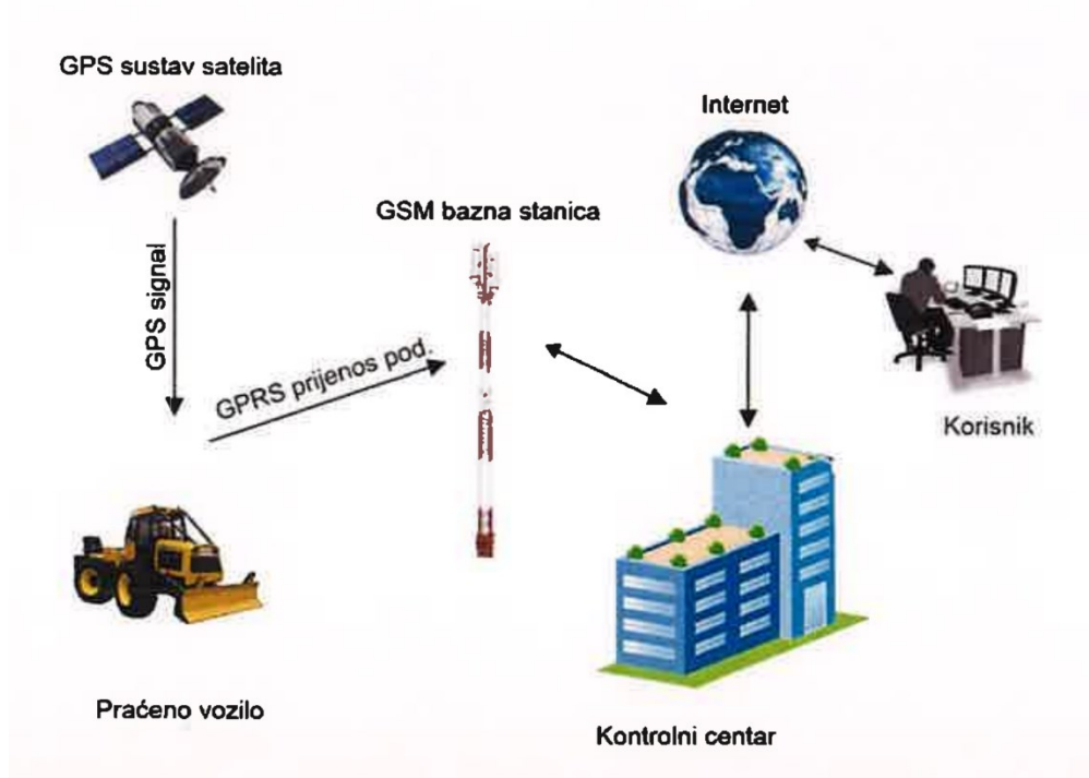
Slika 7. Komunikacijska shema FMS-a [1]
