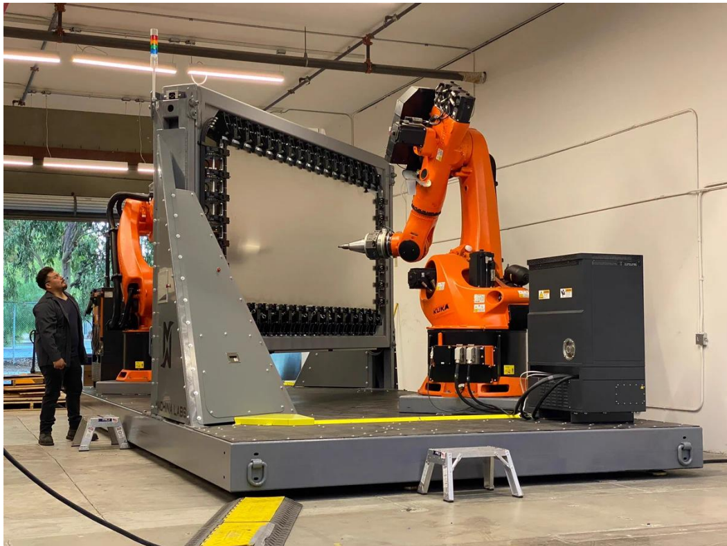
Slika 17. Inkrementalno deformiranje lima pomoću dva robota [13]
