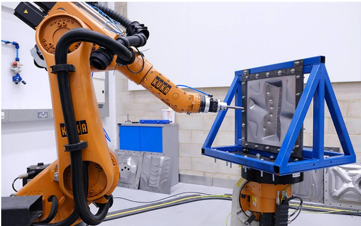
Slika 16. Inkrementalno deformiranje lima pomoću jednog robota [7]
