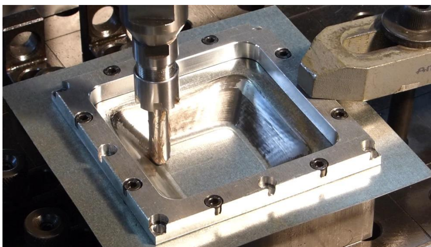
Slika 1. Inkrementalno oblikovanje metala pomoću CNC stroja [2]
