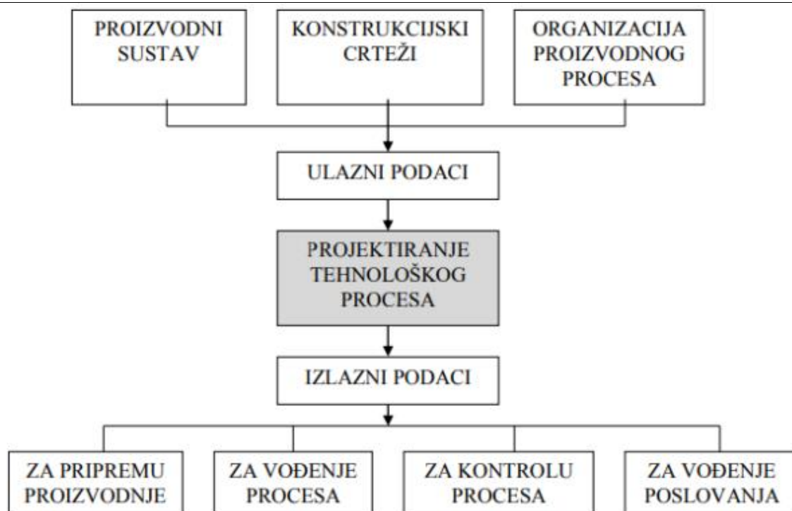
Slika 2. Projektiranje tehnoloških procesa u ukupnom procesu proizvodnje [2]
