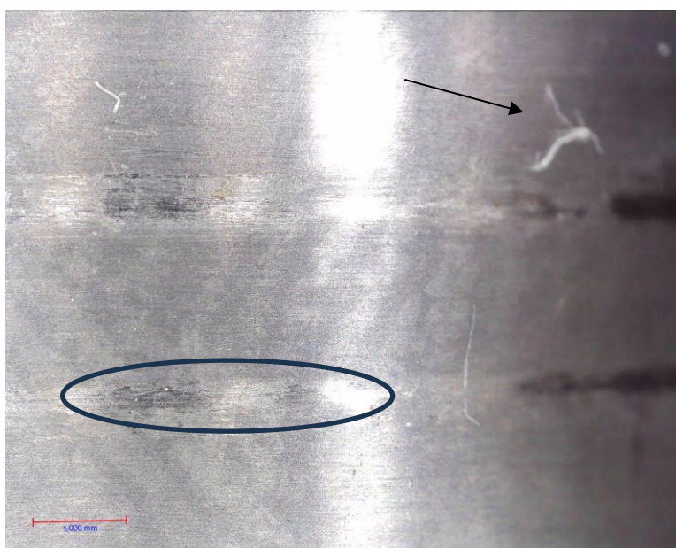
Slika 59. Tragovi trošenja na plinski nitriranom prstenu s prorezom
