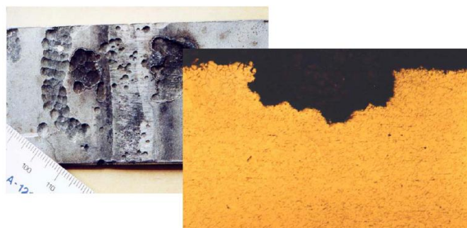
Slika 3. Razaranja materijala pjegastom korozijom [4]
