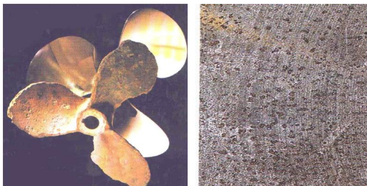
Slika 8. Decinkacija mjedi i grafitizacija sivog lijeva [4]
