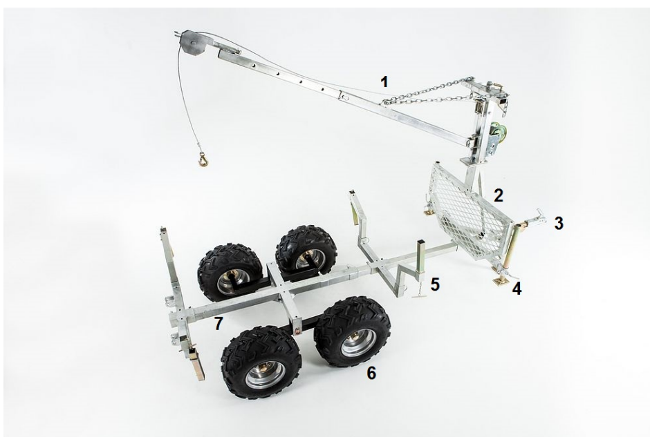
Slika 23. Prikaz glavnih dijelova traktorske prikolice T-Rex [15]
