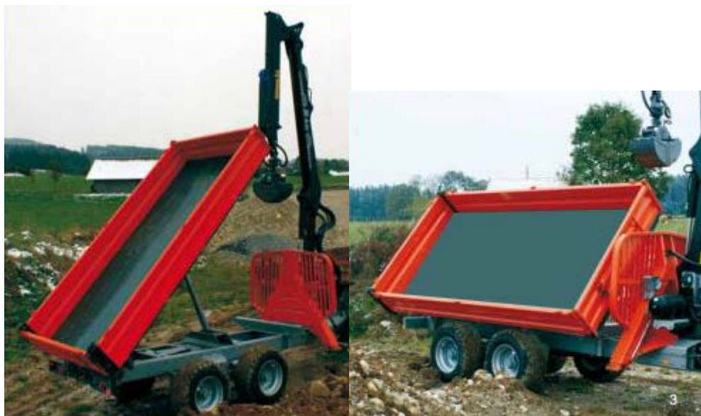
Slika 29. Prikaz stražnjeg i bočnog nagnjanja sanduka prikolice [17]
