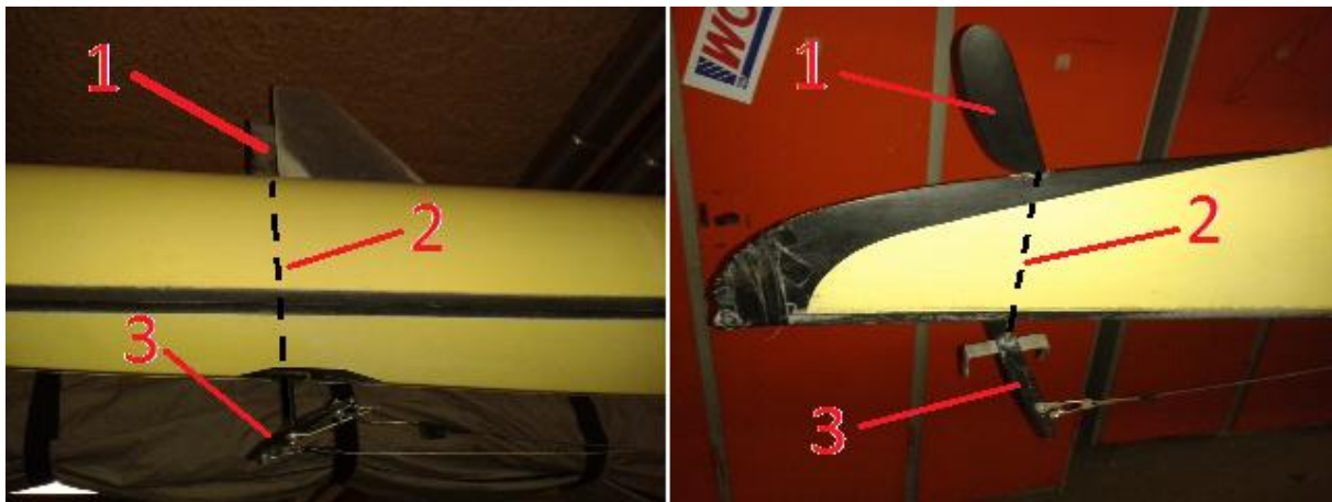
Slika 27. Kormilo spojeno na peraju (lijevo) i kormilo odvojeno od peraje (desno); 1- list kormila; 2- linija vratila kormila; 3- poluga kormila
