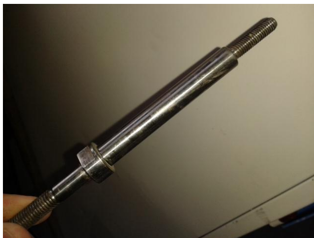
Slika 22. Osovina od ušice od nehrđajućeg čelika
