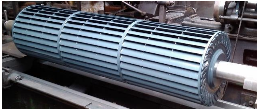
Slika 1 Rotor Ossberger turbine[1]
